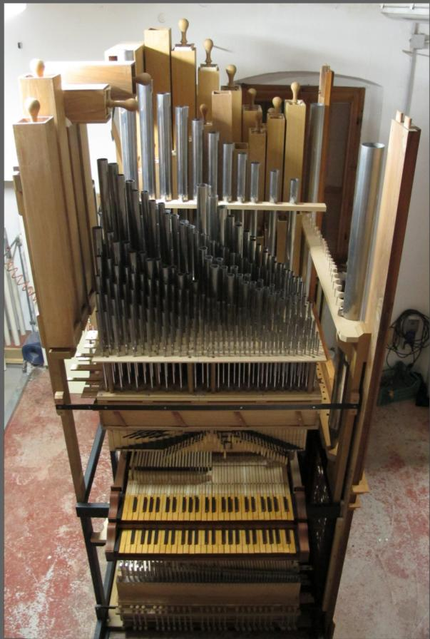
LA TRASMISSIONE DELLO STRUMENTO È PURAMENTE MECCANICA E REALIZZATA CON SOLUZIONI INTELLIGENTI E PRATICHE AL FINE DA RIDURRE LA MANUTENZIONE AL MINIMO, NONOSTANTE IL RIDOTTO SPAZIO UTILIZZATO.
